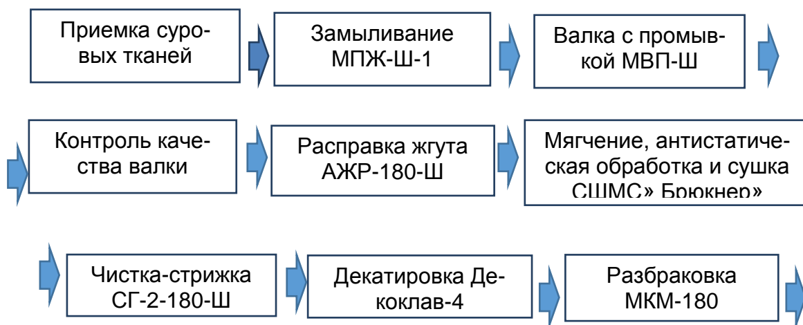
Рисунок 2.22 — Технологические стадии отделки суконных тканей
